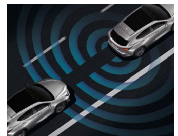
Sistem varnega izstopa uporablja sistem za zaznavanje mrtvega kota in zaznava vozila, ki se približujejo od zadaj, ter po potrebi zaklene vrata in prepreči njihovo odpiranje.
