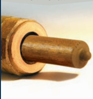
VBRIZGALNA ŠOBA DIZELKEGA GORIVA PO UPORABI ČISTILNEGA SREDSTVA
